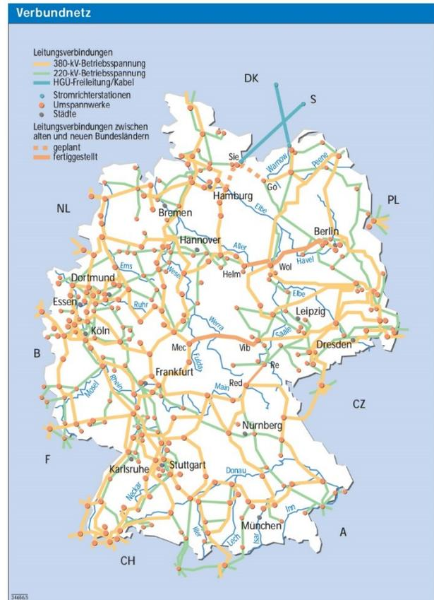
Bild 11 Deutsches Verbundnetz, 50 Hz, Stand: 1.1.1996, (Quelle DVG, mod.)
