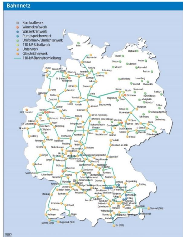
Bild 15 110-kV-Bahnnetz, 16 2/3 Hz, Stand 01.09.1996 [5]
